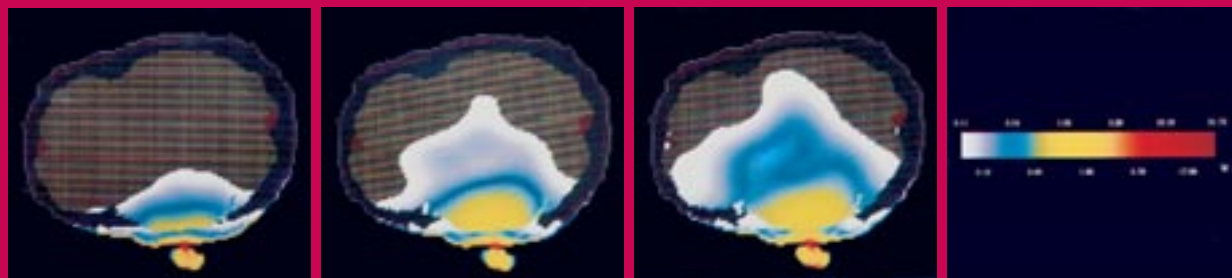
Taux d'absorption spécifiques (TAS) d'une onde hyperfréquence de 835 MHz générée par un téléphone mobile cellulaire dans des modèles de têtes d'adulte (a), d'un enfant de 10 ans (b) et de 5 ans (c) - Echelle de valeur du TAS en W/kg (d).
