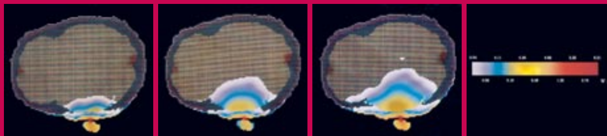
Taux d'absorption spécifiques (TAS) d'une onde hyperfréquence de 1900 MHz générée par un téléphone mobile cellulaire dans des modèles de têtes d'adulte (a), d'un enfant de 10 ans (b) et de 5 ans (c) - Echelle de valeur du TAS en W/kg (d).
